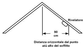
Figura 4: Posizioni perfetta e accettabile di installazione dei rivelatori di fumo e di calore
